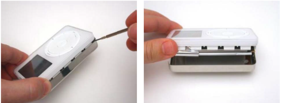
Рис. 1. Вскрытие корпуса AppleIpod ювелирной отверткой
