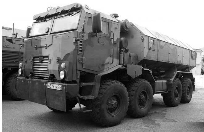
Рис. 3. MRAP на шасси «Урал»
