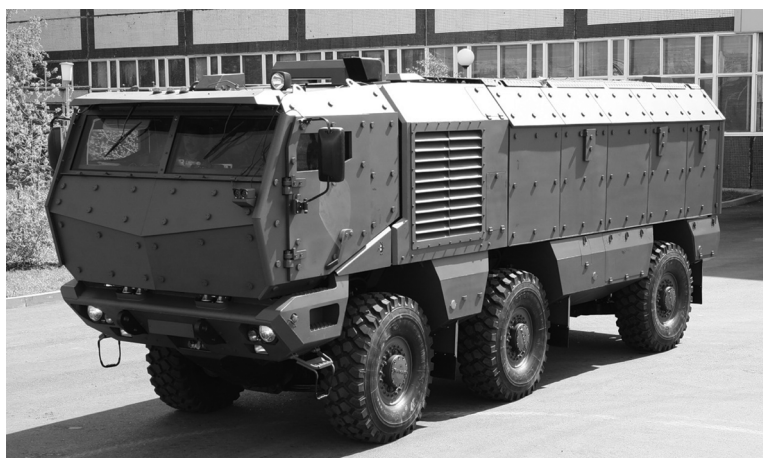
Рис. 6. Автомобиль «Тайфун 6×6», разработанный ОАО «КамАЗ»
