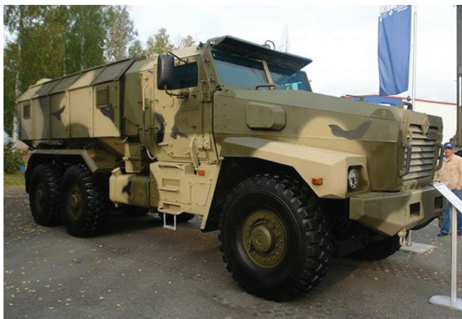
Рис. 5. Автомобиль «Тайфун 6×6», разработанный ОАО «АЗ «Урал»
