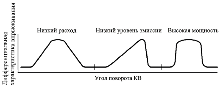
Рис. 2. Идеальные формы характеристики ОВ для минимального расхода, минимальной эмиссии и максимальной мощности [3]
