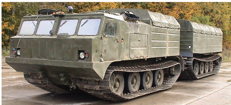
Рис. 5. Двухзвенный гусеничный транспортер ДТ-10П семейства «Витязь»
