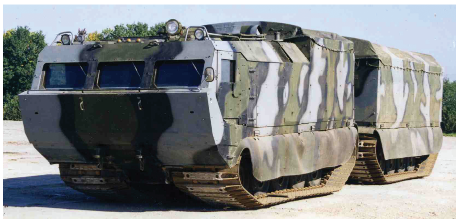
Рис. 6. Двухзвенный гусеничный транспортер ДТ-10ПМ семейства «Вездесущий»
