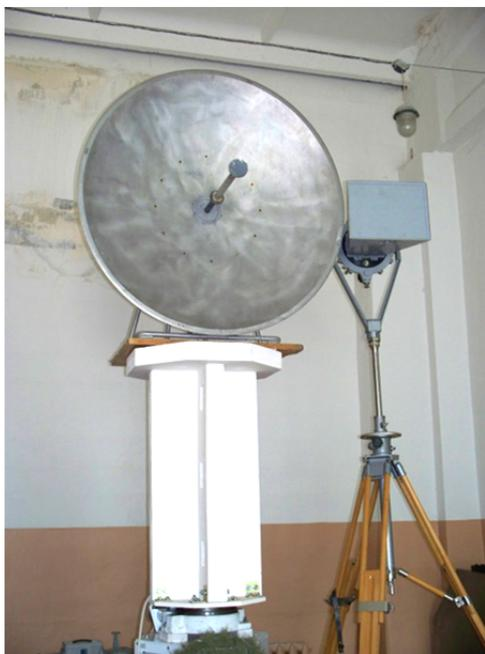
**Рис. 1.** Размещение на ОПУ зеркальной параболической антенны с облучателем обратного излучения трехсантиметрового диапазона
