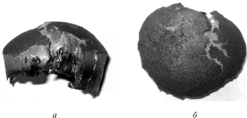
Рис. 5. Стальная пробка, выбитая штатным бронебойным снарядом калибра 30 мм из броневой плиты толщиной 35 мм (масса снаряда 0,402 кг, скорость 715 м/с; средний диаметр пробки 42 мм, масса 0,133 кг):
