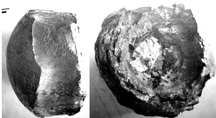
Рис. 4. Стальная пробка, выбитая снарядом калибра 30 мм из броневой плиты толщиной 27 мм (скорость снаряда 860 м/с); слева — полусферическая передняя поверхность пробки, справа — тыльная поверхность той же пробки; диаметр пробки 55...60 мм (снимки предоставлены профессором М.А. Тарасовым)
