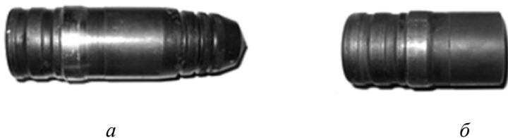
Рис. 9. Штатный бронебойно-трассирующий снаряд (а) и корпус штатного осколочно-фугасного снаряда, подготовленный к заполнению свинцовым сердечником (б) (калибр обоих снарядов 30 мм)
