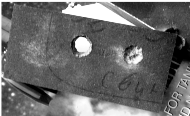
Рис. 3. Сквозная пробойна в броневой плите толщиной 12 мм, оставленная винтовочной свинцовой пулей калибра 8,6 мм; слева — входное отверстие, справа — след от стальной пули (снимок предоставлен профессором М.А. Тарасовым)
