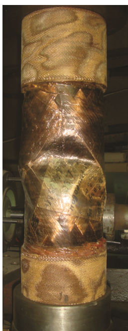
Рис. 5. Вид потери устойчивости сжимаемого трубчатого образца из КМ, испытанного без устройства
