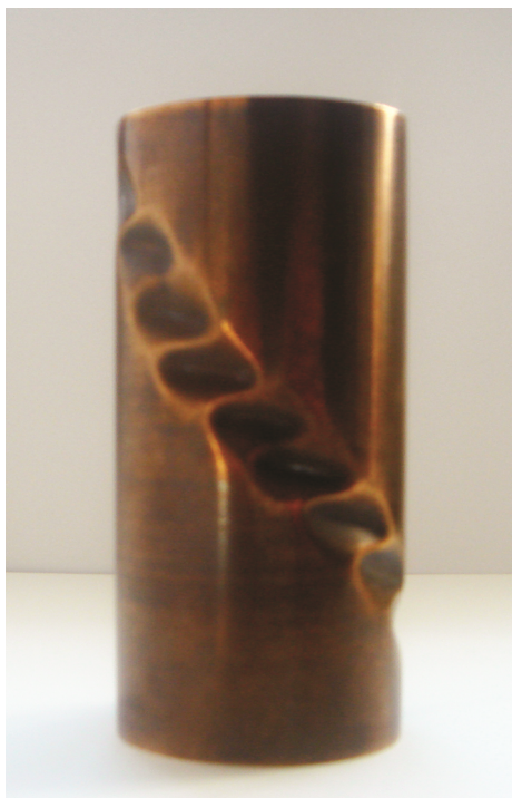
Рис. 3. Вид потери устойчивости сжимаемой бронзовой цилиндрической оболочки с вкладышем
