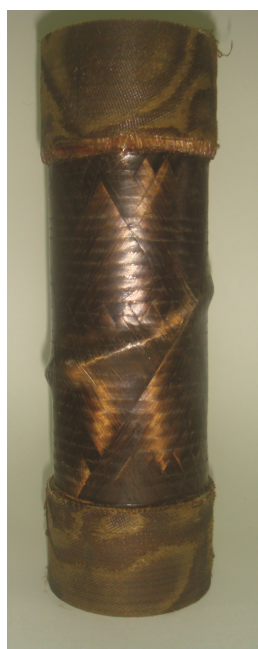
Рис. 6. Вид разрушения сжимаемого трубчатого образца из КМ, испытанного с устройством
