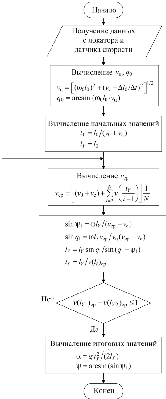
Рис. 3. Алгоритм работы цифрового вычислителя
