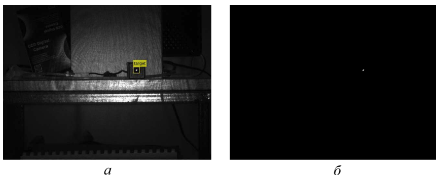
Рис. 4. Результаты работы алгоритма обнаружения с графическим выделением обнаруженной видеокамеры с объективом типа pinhole: а — исходное разностное изображение; б — итоговое бинарное изображение
