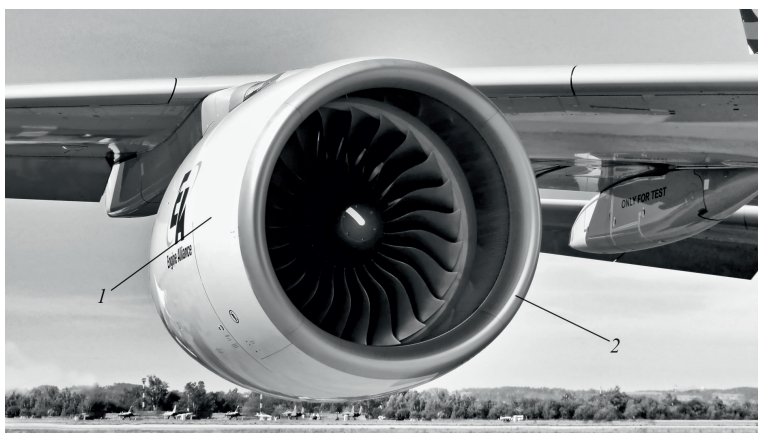
Рис. 1. Авиационный ГТД консорциума EngineAlliance: мотогондола (1), кольцо воздухозаборника (2)
