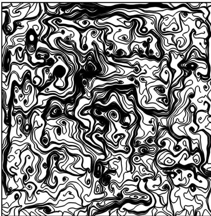
**Рис. 1.** Поле скоростей в сечении  $XY$ , проходящем через центр расчетной области при  $\kappa = 1,0$ ,  $L = 0,01$  м и граничных условиях с прилипанием потока на стенках
