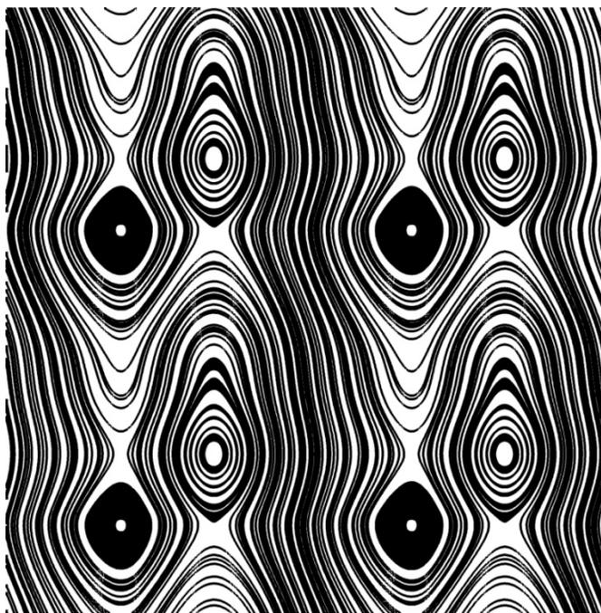
**Рис. 4.** Поле течений на стадии затухания турбулентности в среде с периодическими граничными условиями в сечении, проходящем через центр расчетной области
