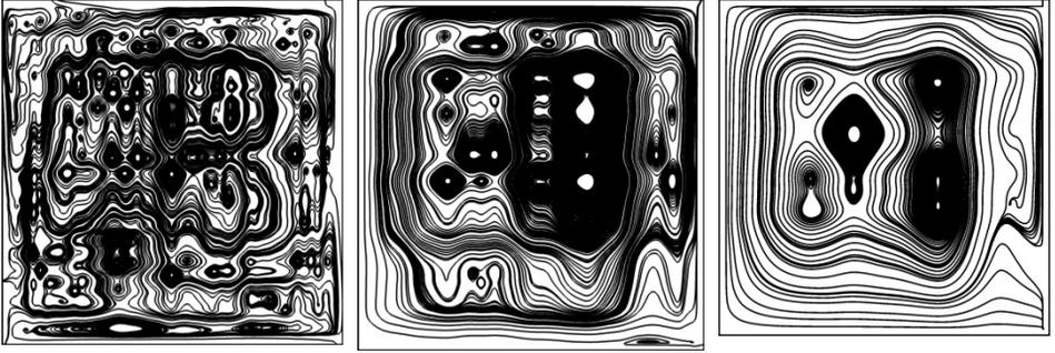
**Рис. 3.** Эволюция вихревых структур на стадии затухания развитой турбулентности в одном из сечений, проходящем через центр расчетной области (условия задачи соответствуют условиям рис. 1)
