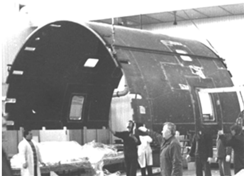
Рис. 1. Трехслойные углепластиковые панели обтекателя РН «Протон», изготовленные в ОАО «ОНПП «Технология»
