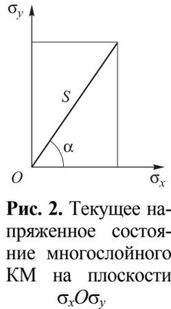
**Рис. 2.** Текущее напряженное состояние многослойного КМ на плоскости  $\sigma_x O \sigma_y$
