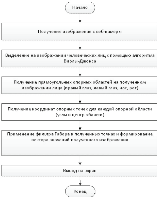
Рис. 2. Блок-схема алгоритма на основе фильтров Габора
