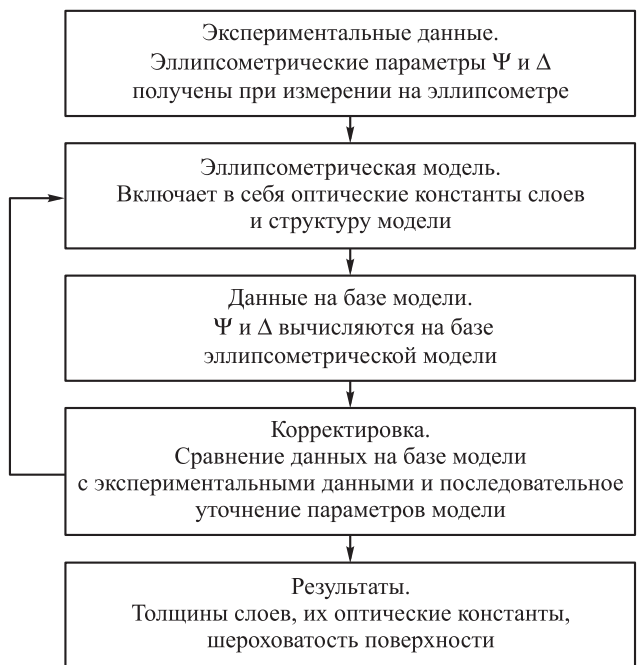
Рис. 2. Алгоритм исследований с помощью ИК-спектрального эллипсометра IR-VASE
