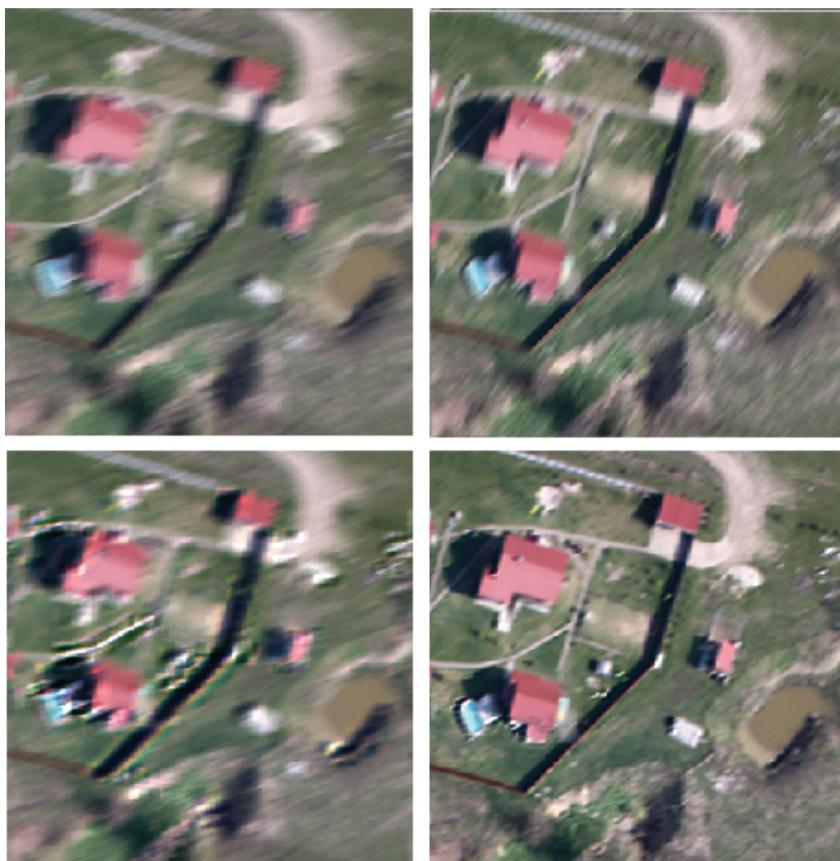
**Рис. 3.** Восстановление изображения по одному и двум кадрам. Вверху два смазанных изображения с гауссовым шумом; слева внизу — результат восстановления классическим методом слепой деконволюции по единственному изображению; справа внизу — результат обработки предложенным в работе методом восстановления по двум смазанным кадрам. Время обработки предложенным методом — 37 с на изображении в  $500 \times 500$  пикселей и искажающей функции в  $18 \times 18$  пикселей
