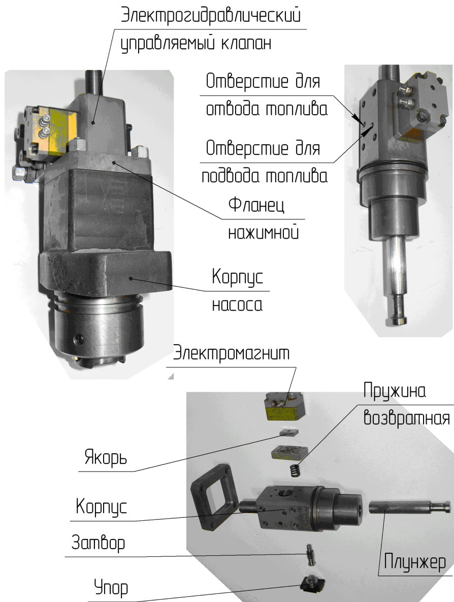
Рис. 9. Общий вид электроуправляемого насоса с электрогидравлическим клапаном, предназначенного для дизеля 12ЧН 26/26
