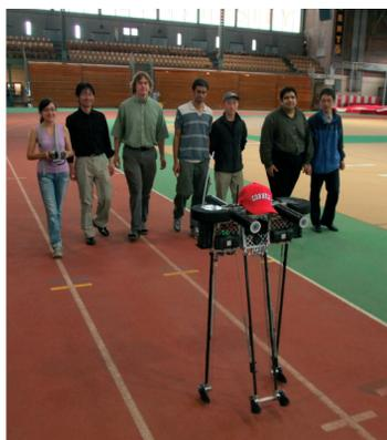
**Рис. 11.** Энергетически эффективный робот Ranger на основе пассивной динамики, разработанный в Корнельском университете
