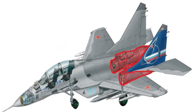
Рис. 7. Конструкция силовой установки самолета МиГ-29К
