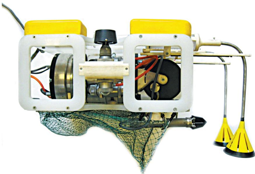
**Рис. 1.** Гидробот «Акватор II» в состоянии готовности к работе на донном полигоне опытового бассейна NBL NASA
