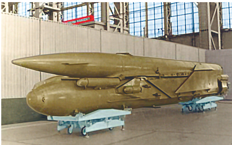
Рис. 6. Стартовая конфигурация КР «Метеорит-М» морского базирования
