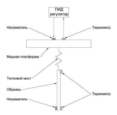
Функциональная схема установки для калибровки термометров
