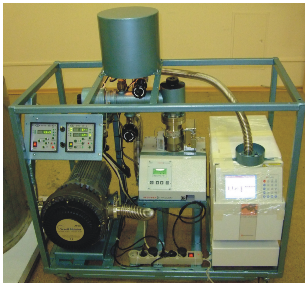
Рис. 13. Вакуумный пост с контролем герметичности ВПГ-250/500
