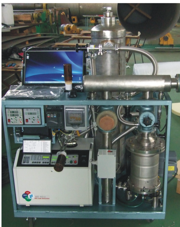
Рис. 14. Стенд контроля герметичности ВПКТ-500
