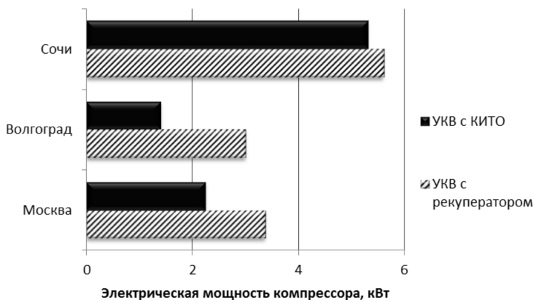
Рис. 6. Электрическая мощность, потребляемая компрессорами сравниваемых установок, в различных климатических зонах (параметры подаваемого воздуха и воздуха в помещении постоянны)
