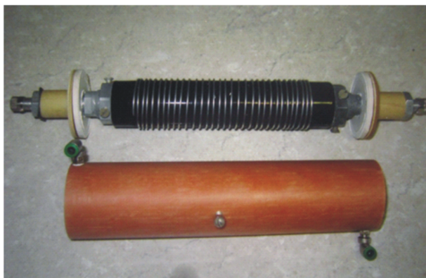
Рис. 3. Генератор озона с поверхностным разрядом (вверху электрод в сборе, внизу корпус из винилпластовой трубы с устройством для подвода высокого напряжения к спирали)
