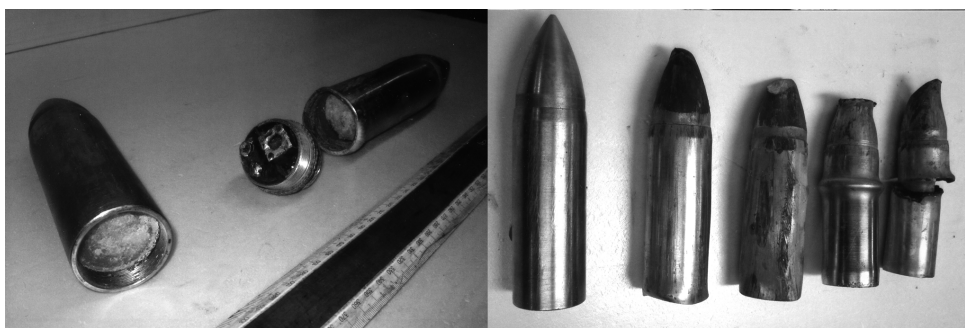
Рис. 7. Состояние ударника до (крайний слева) и после проведения опыта; слева в центре на фото — измерительный узел на основании (после проведения опыта); справа — виды деформирования ударников после остановки в улавливающем устройстве
