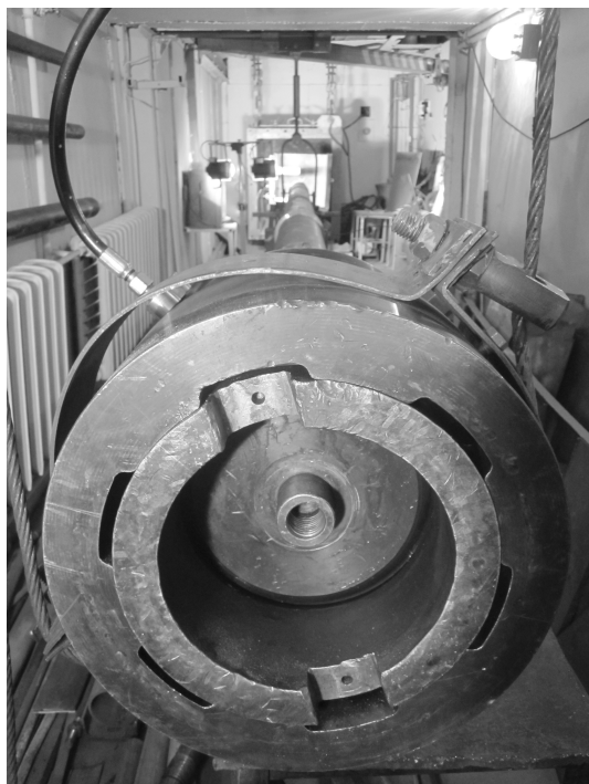
Рис. 2. Вид в направлении ствола баллистической установки на камеру высокого давления в закрытом состоянии
