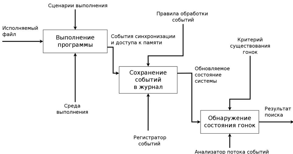
**Рис. 2. Схема генерации и обработки событий**
