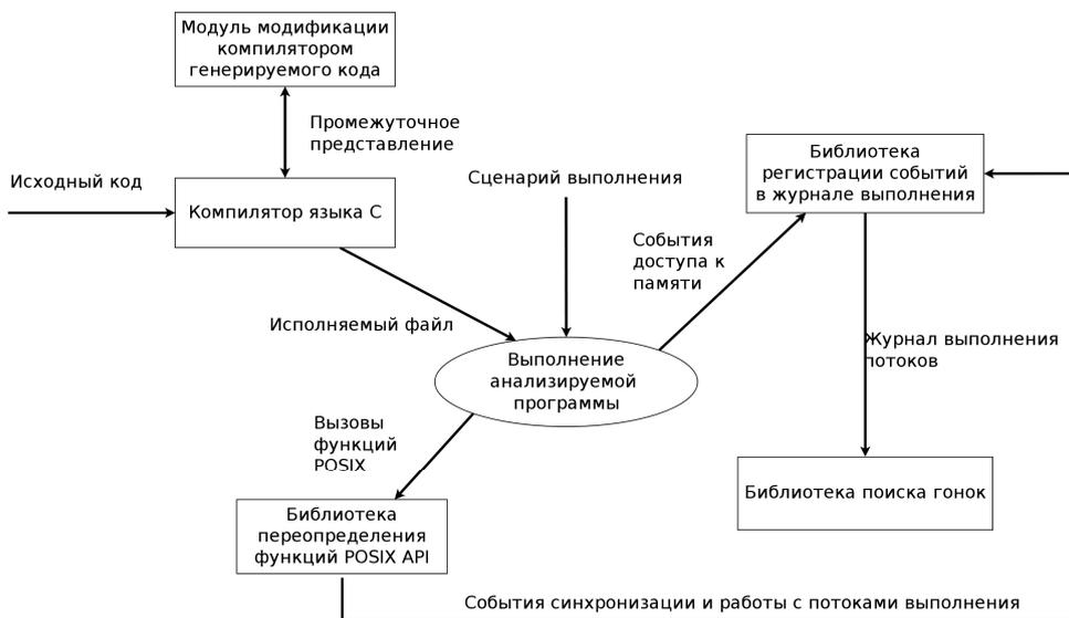
**Рис. 3. Структура динамического анализатора**
