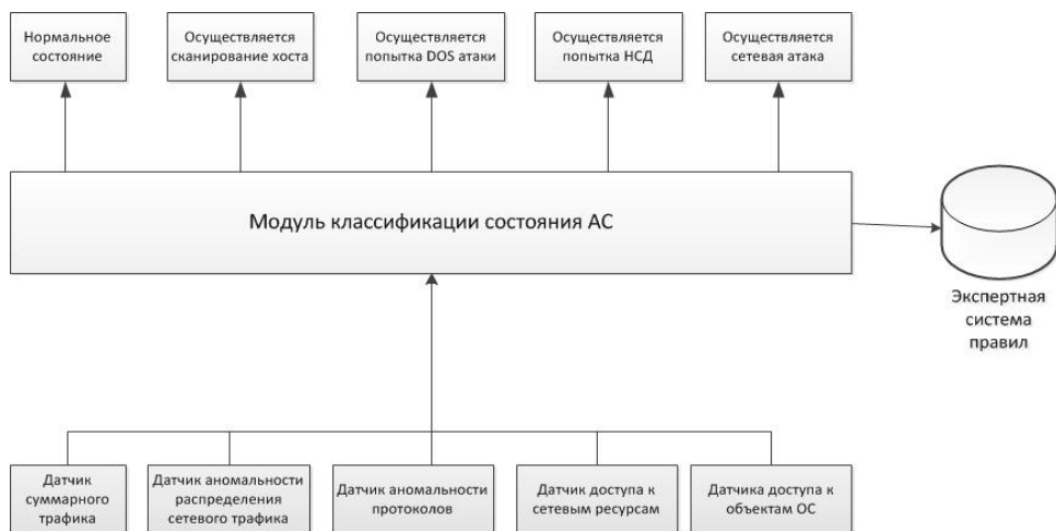
Рис. 3. Схема взаимодействия датчиков СОПВ с модулем классификации состояний АС
