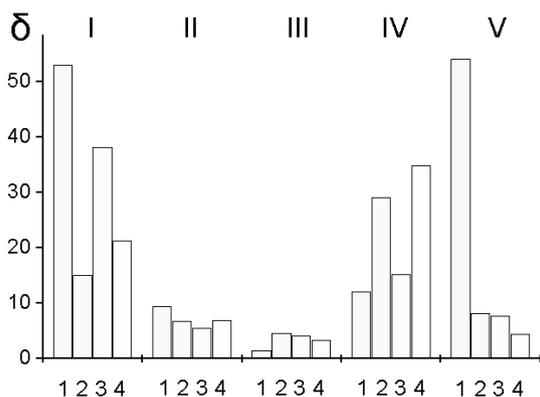
**Рис. 1. Ошибки определения концентраций газов в шестикомпонентной смеси:** I — этилен; II — аммиак; III — метанол; IV — этанол; V — изопропанол (углекислый газ на рис. не приведен)
