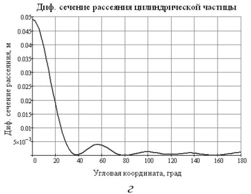
**Рис. 5. Результаты верификации алгоритма определения характеристик рассеяния для одиночной цилиндрической частицы с параметрами  $D = 1,6 \lambda = 160$  отн. ед. ( $\lambda = 100$  отн. ед.),  $\varepsilon = 4$ :**
