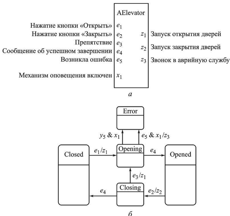
Рис. 5. Схема связей (а) и граф переходов (б) автомата AElevator
