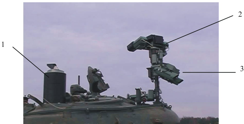
Рис. 4. Размещение средств видеонаблюдения на объекте управления
