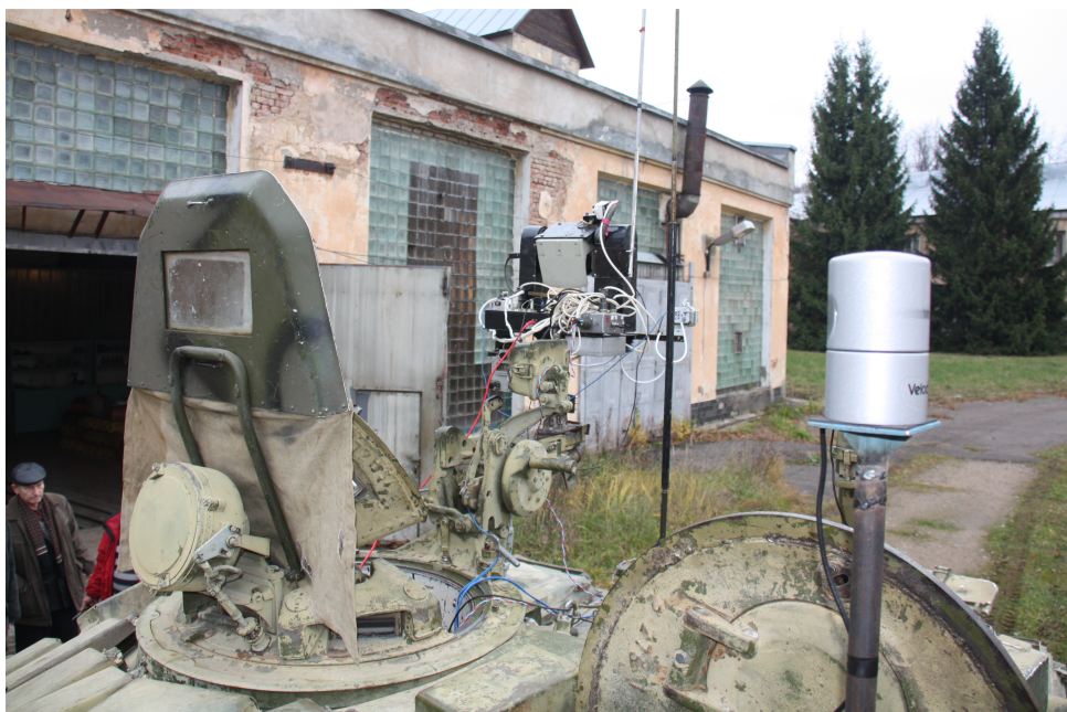
Рис. 13. Размещение СТЗ кругового обзора на объекте
