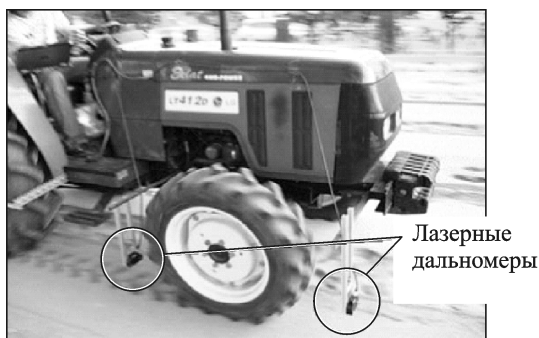
Рис. 1. Расположение датчиков для определения глубины колеи
