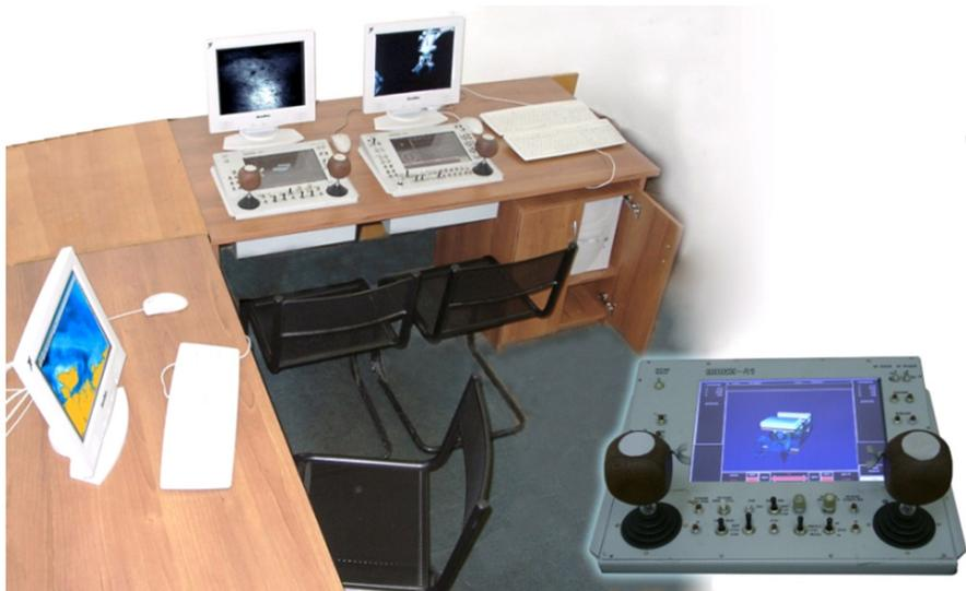
**Рис. 1. Береговой ТК для подготовки операторов подводных аппаратов**
