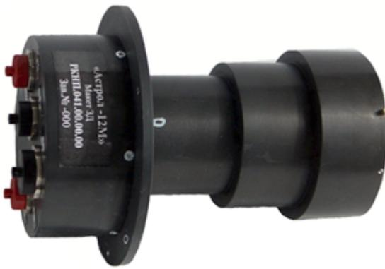
**Рис. 2. Внешний вид звездного прибора “Астрол-12М”**
