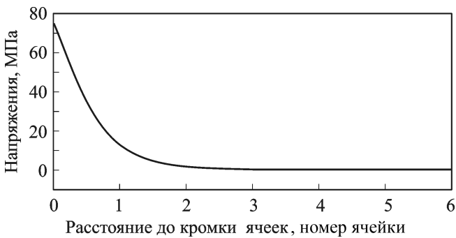
Рис. 7. Зависимость межслойных сдвиговых напряжений от расстояния до кромки материала для ячейек представительного объема
