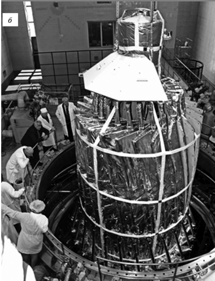
Рис. 5. Распределение температур в конструкции фокального модуля КРТ (а) и вид фокального модуля в составе КРТ в ходе тепловакуумных испытаний (б)
