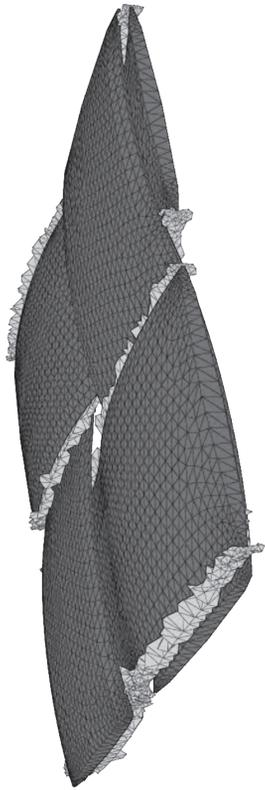
Рис. 5. Процесс распространения микротрещин в матрице ЯП тканевого КМ: трещина и волокна (слева), компонента тензора напряжений  $\sigma_{11}$  в ЯП (справа)
