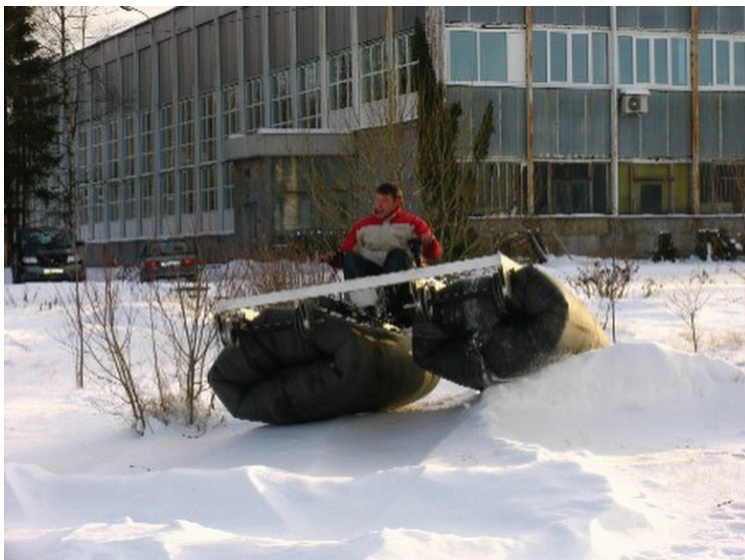
Рис. 3. Экспериментальная тележка НИЦИАМТ ФГУП «НАМИ» на торовых движителях
