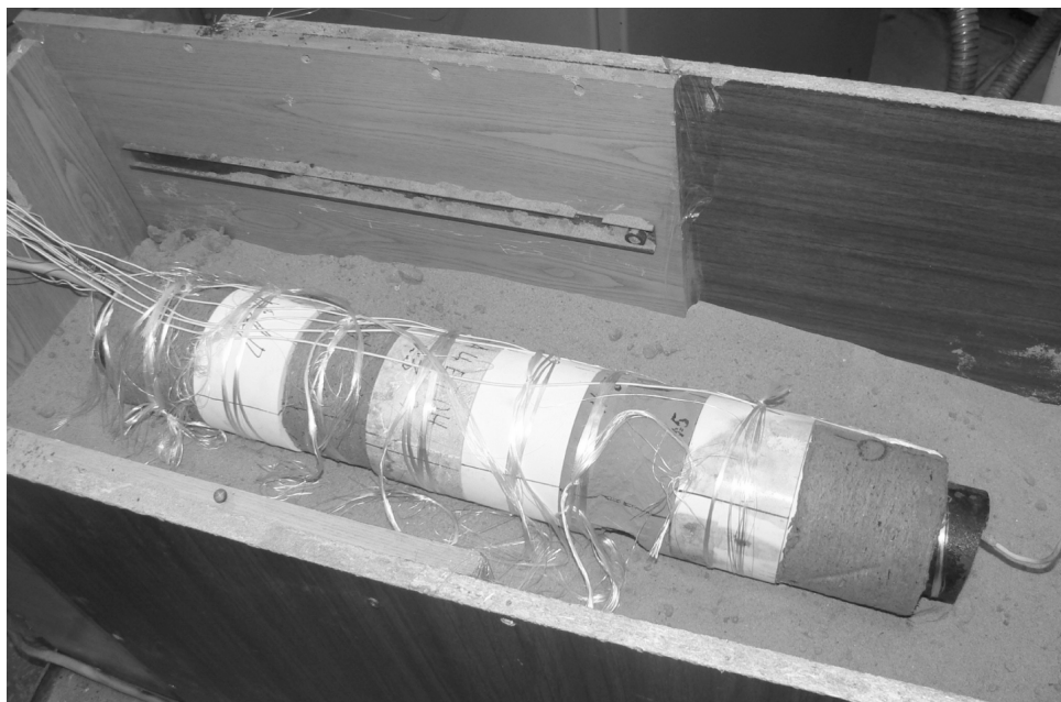
Рис. 3. Стенд для тепловых испытаний
