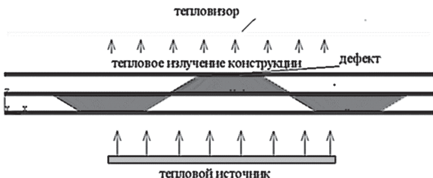
Рис. 2. Схема нагрева и тепловизионных измерений трехслойной сварной конструкции
