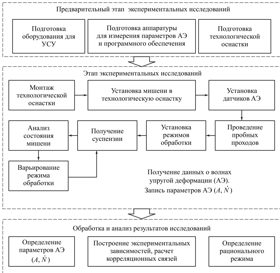
Рис. 7. Структурная схема инженерного информационно-аналитического обеспечения технологии УСУ
