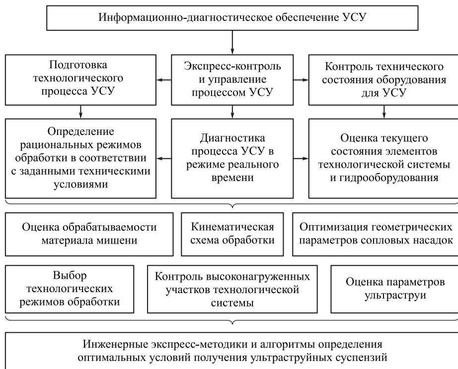
Рис. 6. Возможности и направления применения метода АЭ в технологии УСУ
