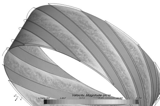
Рис. 3. Скорость газа в зазоре (абсолютная величина) при скорости вращения ротора  $\omega = 15\,000$  об/мин
