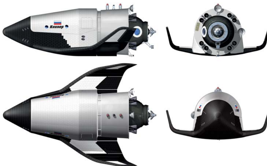
Рис. 1. Кессонное крыло малого удлинения российского многоразового аэрокосмического аппарата «Клипер» РКК «Энергия»
