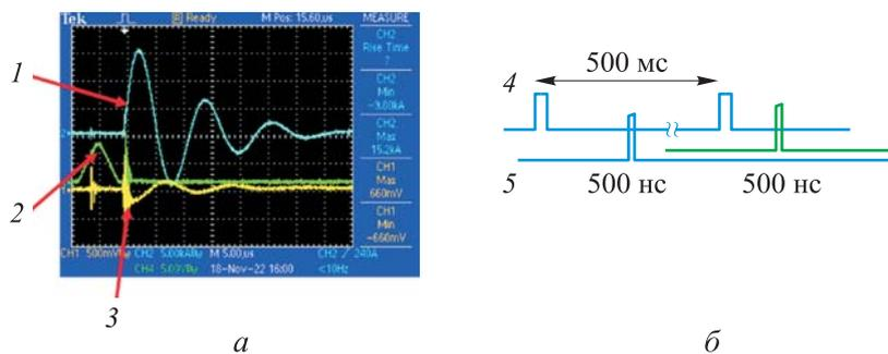
**Рис. 7.** Синхронизация запусков поджига и разряда магнитоплазменного компрессора: а — осциллограмма при случайном инициировании разряда МПК вынесенным поджигом (1 — ток разряда МПК; 2 — сигнал с датчика тока через усилитель 322 мВ и примерно 4,1 мВ напрямую; 3 — ток разряда свечи); б — синхрограмма (4 — импульсы поджига свечи; 5 — импульсы команды на запуск тиратрона)
