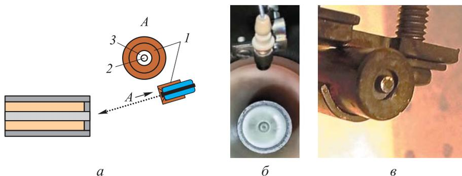
**Рис. 4.** Система дистанционного поджига магнитоплазменного компрессора: *а* — схема взаимного расположения свечи и МПК; *б* — свеча вне области воздействия основного потока плазмы разряда МПК; *в* — свеча поджига
