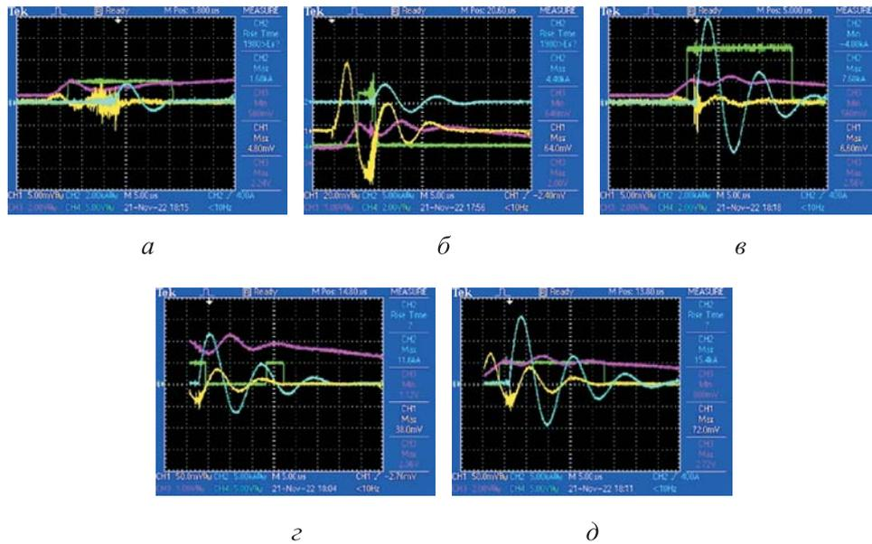
**Рис. 9.** Осциллограммы синхронизированных сигналов мониторов тока магнитоплазменного компрессора и тока свечи поджига при различных напряжениях заряда основного конденсатора  $U_c$ , равного 2,5 кВ (а), 5 кВ МПК (б), 10 кВ (в), 15 кВ (г), 20 кВ (д)
