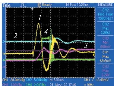
**Рис. 8.** Осциллограмма сигналов при синхронизации поджига и включения тиратрона:
