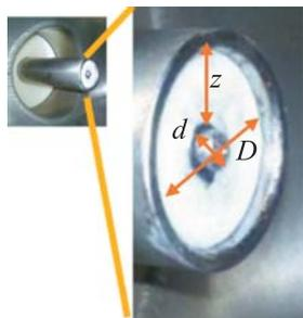
**Рис. 1.** Фотография магнито-плазменного компрессора в вакуумной камере
