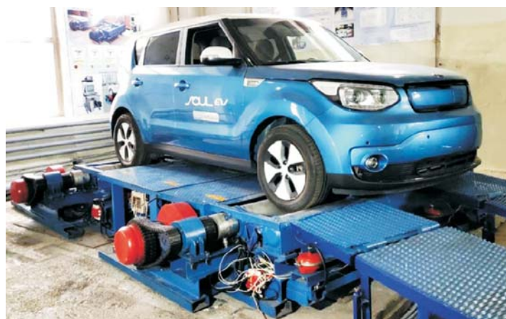
Рис. 5. Внешний вид исследовательского стендового комплекса ИРНТУ с установленным автомобилем Kia Soul EV
