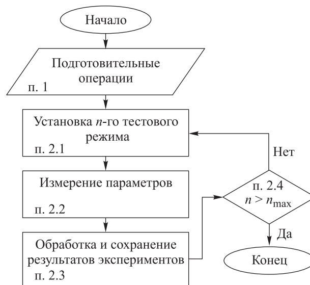
Рис. 1. Алгоритм проведения экспериментальных исследований процесса функционирования автомобиля с ДСКС на стенде с беговыми барабанами
