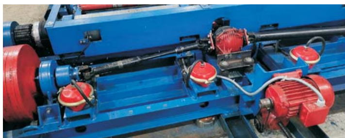
Рис. 4. Внешний вид механизма подъема стенда с пневмокамерами
