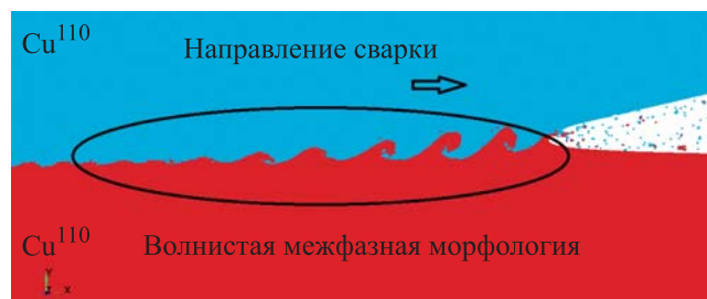
Рис. 4. Морфология волнистой поверхности и формирование крючков
