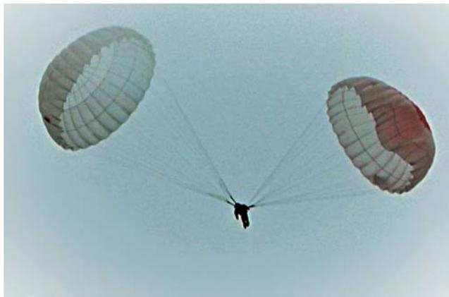
**Рис. 7.** Взаимное положение двух статически неустойчивых парашютов
