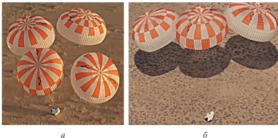
**Рис. 2.** Расчетная конфигурация четырехкупольной (а) и трехкупольной (б) парашютной системы КСА Crew Dragon на этапе конечного спуска
