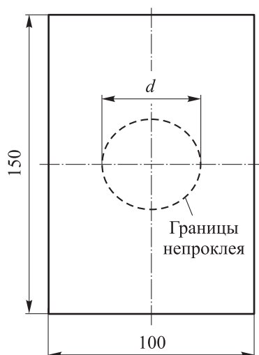
Рис. 3. Эскиз пластины с предварительным дефектом круглой формы, d = 62 мм — диаметр дефекта
