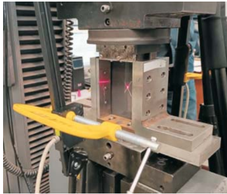
Рис. 4. Испытание пластины с круглым непроклеем:
