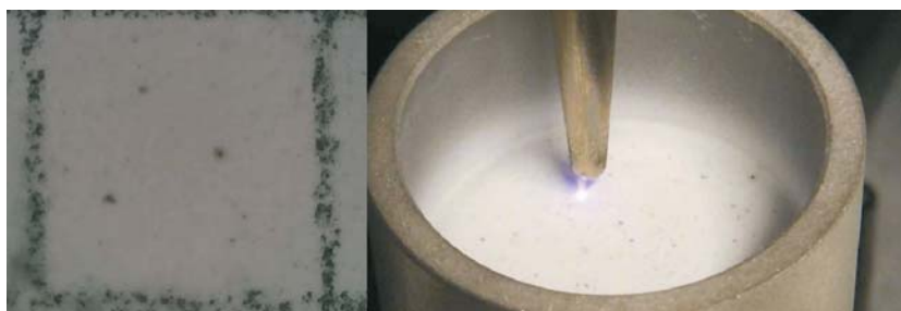
Рис. 11. Проводящие включения в детонационном напылении
